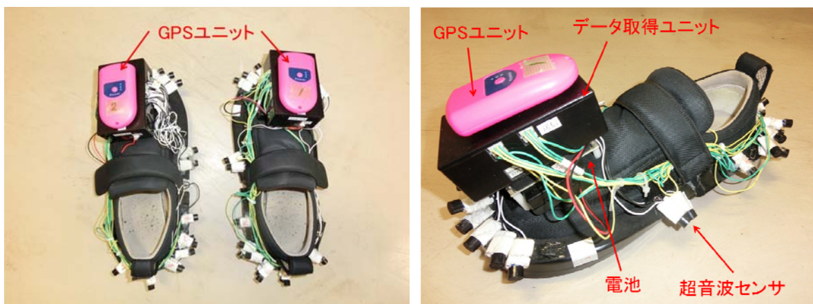
図2 システム外観写真
