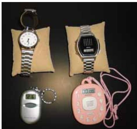
図5 触読時計，音声時計，音声タイマー
