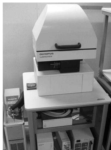
Fig. 2 長期測定用発光イメージング装置:Luminoview。Box直下にEMCCDが装着されている。
